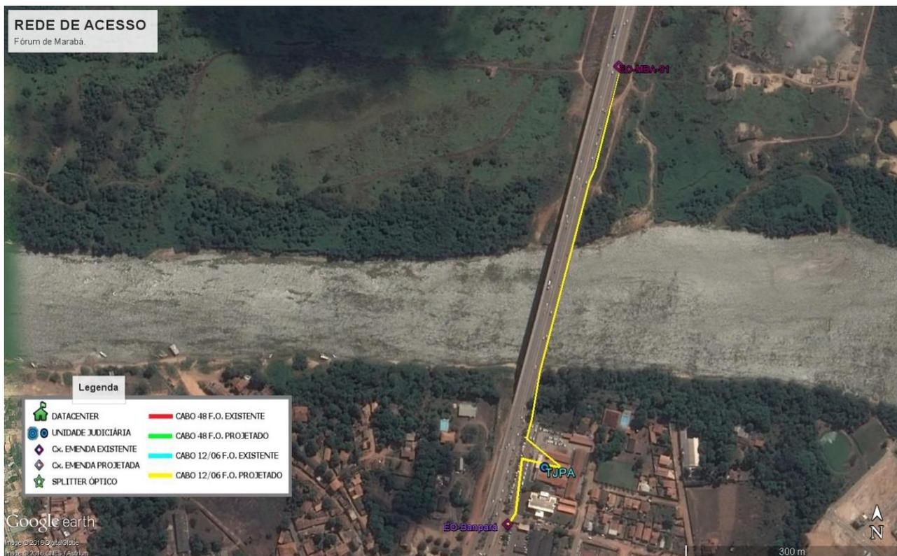
Figura 8 – extraída da ferramenta Google Earth, evidenciando o traçado proposta para a rede de acesso do Fórum de Marabá.
