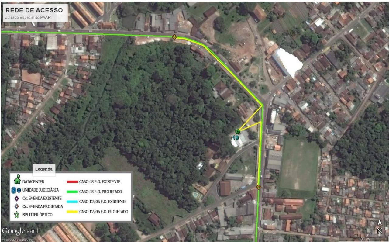
Figura 4 – Extraída da ferramenta Google Earth, evidenciando o traçado proposta para a rede de acesso do Juizado do PAAR, em Ananindeua.
