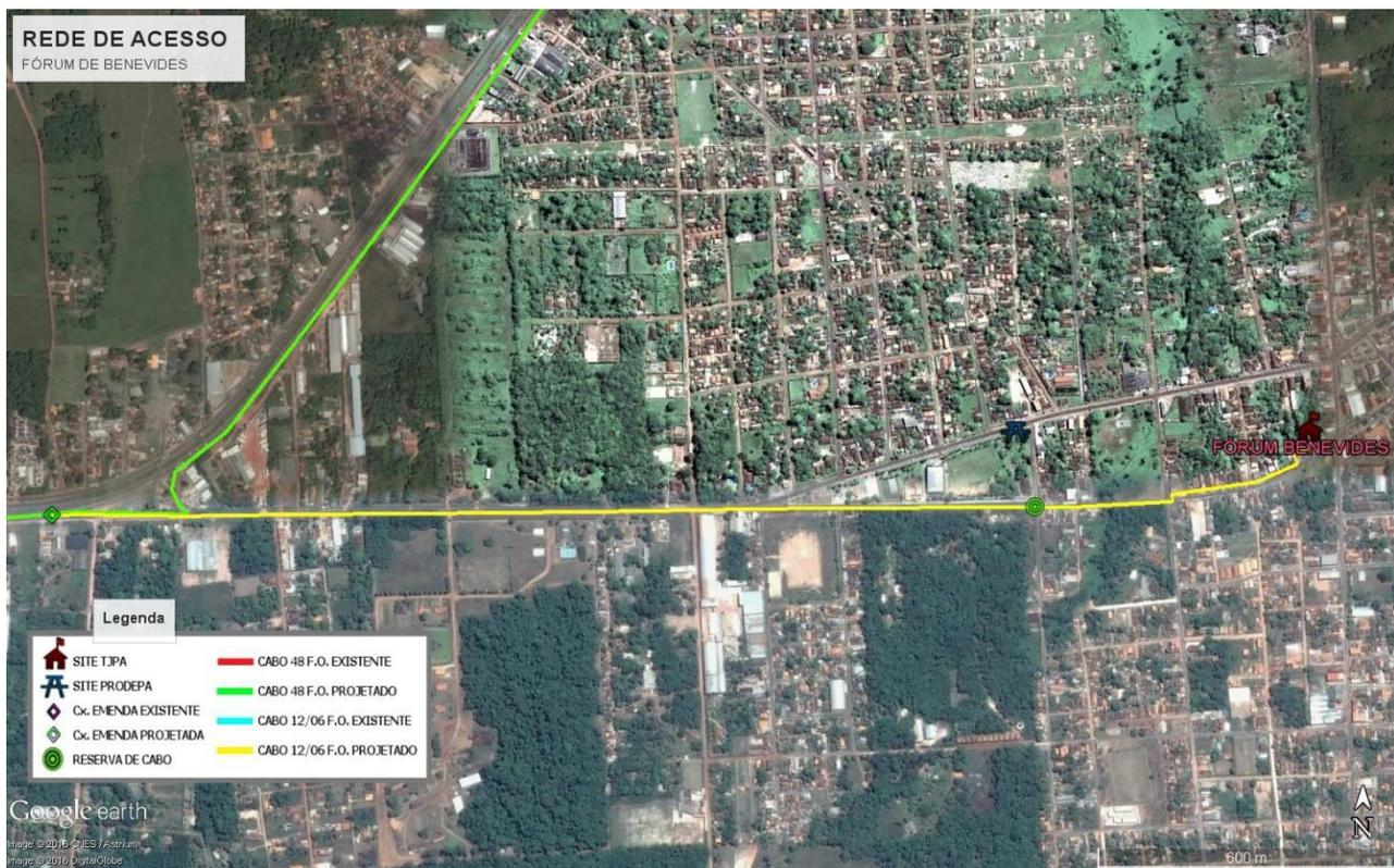
Figura 6 – extraída da ferramenta Google Earth, evidenciando o traçado proposta para a rede de acesso do Fórum de Benevides.
