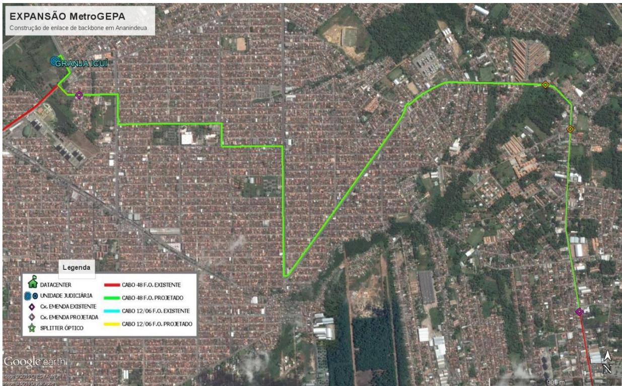
Figura 2 – Extraída da ferramenta Google Earth, evidenciando o traçado proposto para a expansão do *backbone* da rede MetroGEPA, em Ananindeua.
