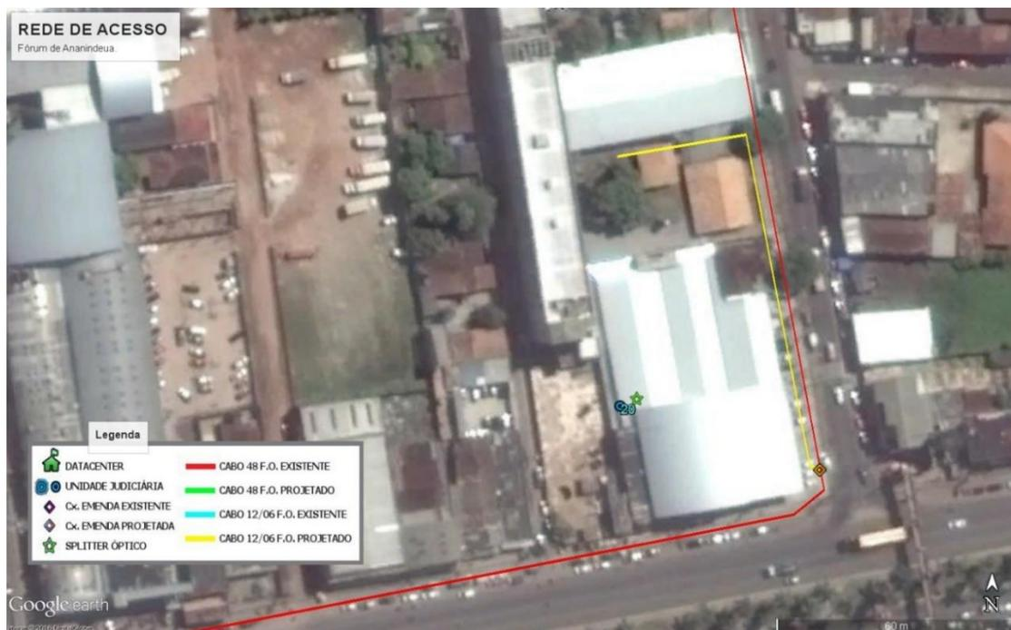
Figura 3 – Extraída da ferramenta Google Earth, evidenciando o traçado proposta para a rede de acesso do Fórum de Ananindeua.
