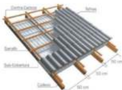
Execução da manta de subcobertura
