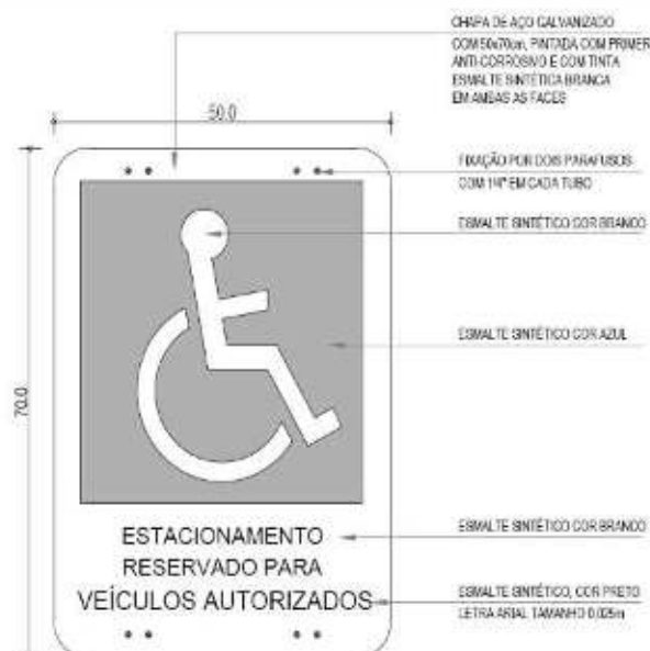
SV.05 - PLACA DE ESTACIONAMENTO MODELO 1 DIMENSÕES EM CENTÍMETROS
