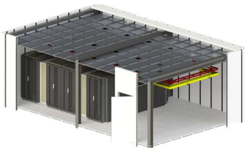
Figura 29 – Croqui em corte da sala segura
