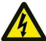
A sinalização de alerta deve ser instalada em local visível e a uma altura de 1,8 m medida do piso acabado à base da sinalização, próxima ao risco isolado ou distribuída ao longo da área de risco generalizado, distanciadas entre si em, no máximo, 15 m.
